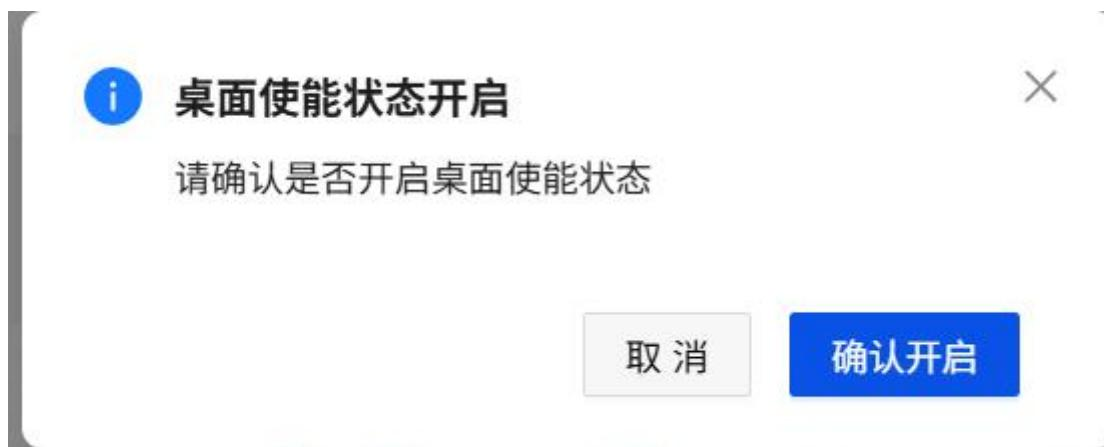
【桌面使能】保留状态【开启】后，若重启工智机，非实时域系统（桌面）将正常启动，并支持对其进行开机、关机和重启操作。
