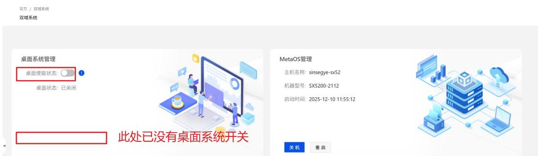
【桌面使能】保留状态【关闭】后，若重启工智机，非实时域（桌面）将保持关闭状态，且不会自动启动。
